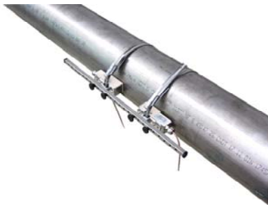
Abbildung 7 Ultraschallwandler mit Montageschiene auf etwa 9 Uhr montiert
