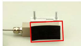
Abbildung 6 Verwendung akustischer Koppelfolie
