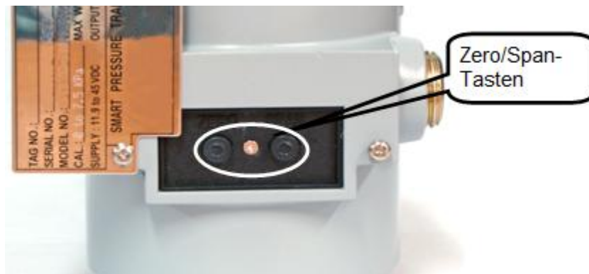
Abb. 4-4 Tasten für Nullpunkt- und Span-Konfiguration des Messumformers
