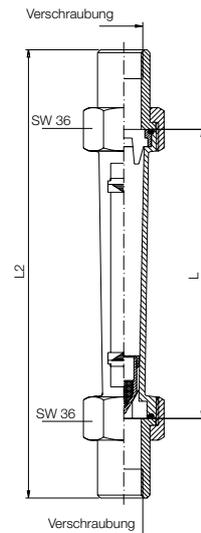
**Abmessungen (mit Sonderverschraubungen aus PVC oder Temperguss) IG**
