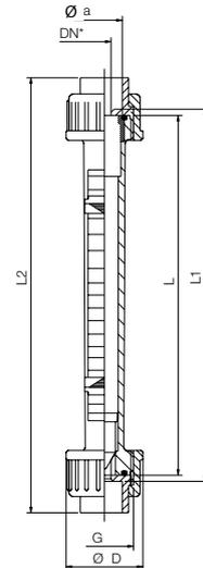
**Abmessungen (mit Sonderverschraubungen aus Messing oder Edelstahl)
