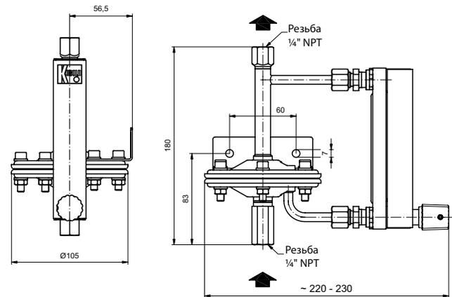
с регулятором дифференциального давления с постоянным входным давлением
