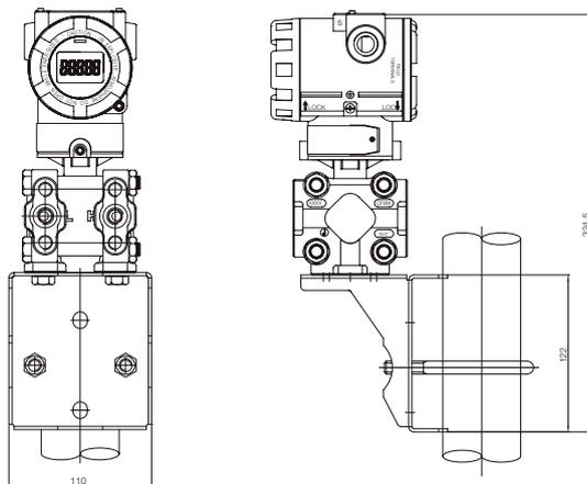
**PAD Standard mit Flachkonsole (vertikal montiert)<sup>1)</sup>**
