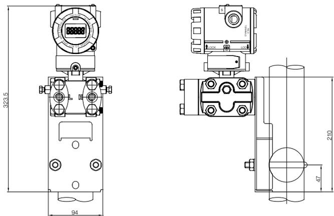
**PAD Standard mit Flachkonsole (horizontal montiert)<sup>1)</sup>**
