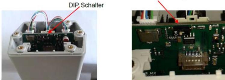
Alternativ dazu kann auch ein 120R Widerstand im Stecker zwischen Pin 2 und Pin 4 verbaut werden. Beim Zusammenbau auf korrekten Sitz der Gehäusedichtung achten.
