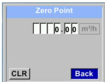
Zeigt der Sensor im eingebauten Zustand ohne Durchfluß bereits einen Durchflußwert von > 0 m³/h kann man hier den Nullpunkt der Kennlinie setzen.
