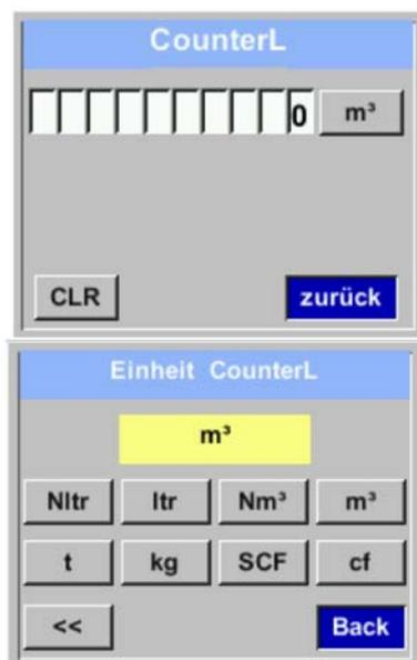
Um Änderungen, z.B. der Einheit, vorzunehmen, muss mittels Taste „ $\Delta$ “ das Tastenfeld „Einheit“ angewählt werden und anschließend mit Taste „OK“ auswählen. Gewünschte Einheit mit Taste „ $\Delta$ “ auswählen und 2x mit Taste „OK“ bestätigen / übernehmen.
