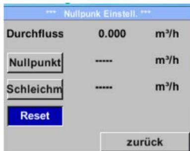
Durch Auswahl „Reset“ werden Festlegungen für „Nullpunkt“ bzw. „Schleichmenge“ zurückgesetzt.
