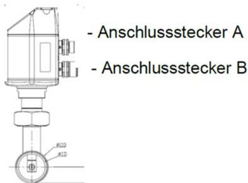
**Achtung:** nicht benötigte Anschlüsse (NC) dürfen nicht auf Potenzial und/oder Erde gelegt werden. Leitungen abschneiden und isolieren.
