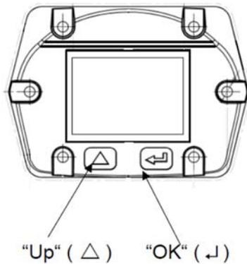
Die Bedienung des KEP-2 erfolgt über die beiden kapazitiven Tasten Up ( $\Delta$ ) und Enter ( $\leftarrow$ ).
