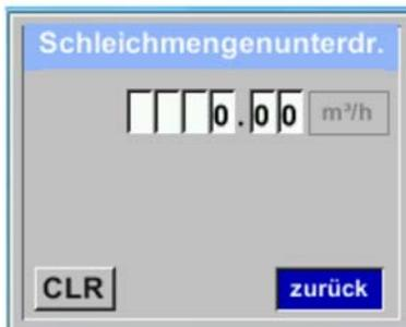
Die Schleichmengenunterdrückung kommt in Anwendung um Verbrauchswerte unterhalb des definierten „LowFlow Cut off“ Wertes als 0 m<sup>3</sup>/h anzuzeigen und auch nicht zum Verbrauchszählerstand zu addieren.
