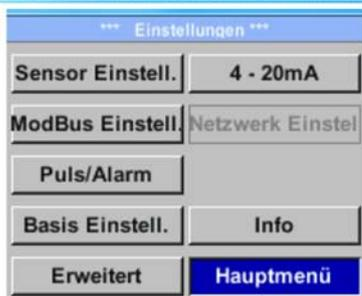
Einen Menüpunkt anzuwählen, Werte zu ändern muss die Taste „ $\Delta$ “ bestätigt werden, die Menüpunktauswahl sowie die Werte Bestätigung erfolgt mit der Taste „OK“
