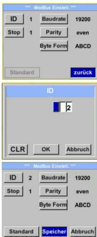
Um Änderungen, z.B. der Sensor ID, vorzunehmen, wird mittels Taste „ $\Delta$ “ das Feld „ID“ selektiert und anschließend mit Taste „OK“ ausgewählt.
