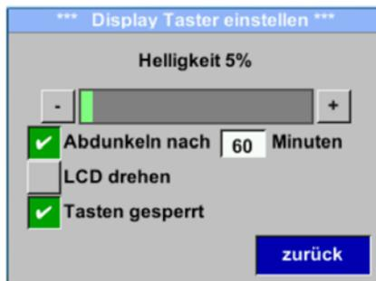
Mit Taste „-“ und Tasten „+“ kann man die Displayhintergrundhelligkeit verändern. Helligkeitswert wird in Diagramm „Helligkeit“ dargestellt.
