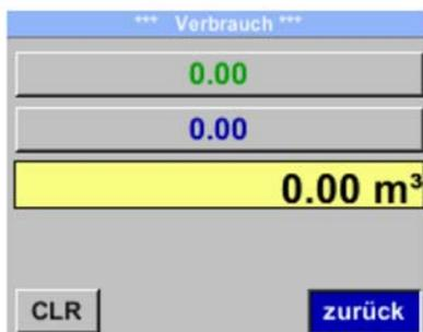
Um die Zählerstände zu ändern zuerst mittels der Taste „ $\Delta$ “ den entsprechenden Zähler anwählen und mit „OK“ bestätigen
