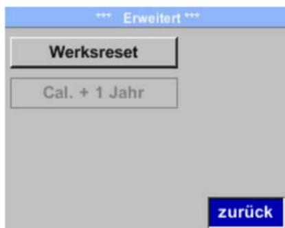
Mit Taste „Werksreset“ kann man den Sensor auf die Werkseinstellungen zurücksetzen.
