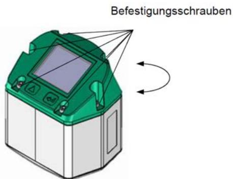
Die Position des Displaykopfs ist um 180° drehbar dies z.B. im Fall bei umgekehrter Strömungsrichtung.
