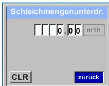
Die Schleichmengenunterdrückung kommt in Anwendung um Verbrauchswerte unterhalb des definierten „LowFlow Cut off“ Wertes als 0 m<sup>3</sup>/h anzuzeigen und auch nicht zum Verbrauchszählerstand zu addieren.
